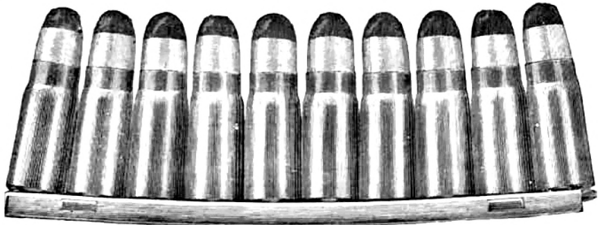
Fig. 2. — Chargeur de dix cartouches (grandeur naturelle).
