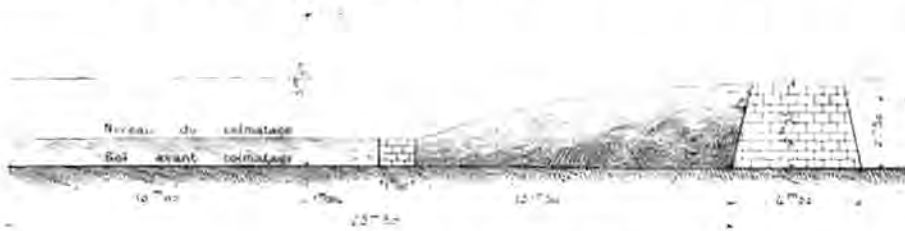
Les petites digues provisoires.
